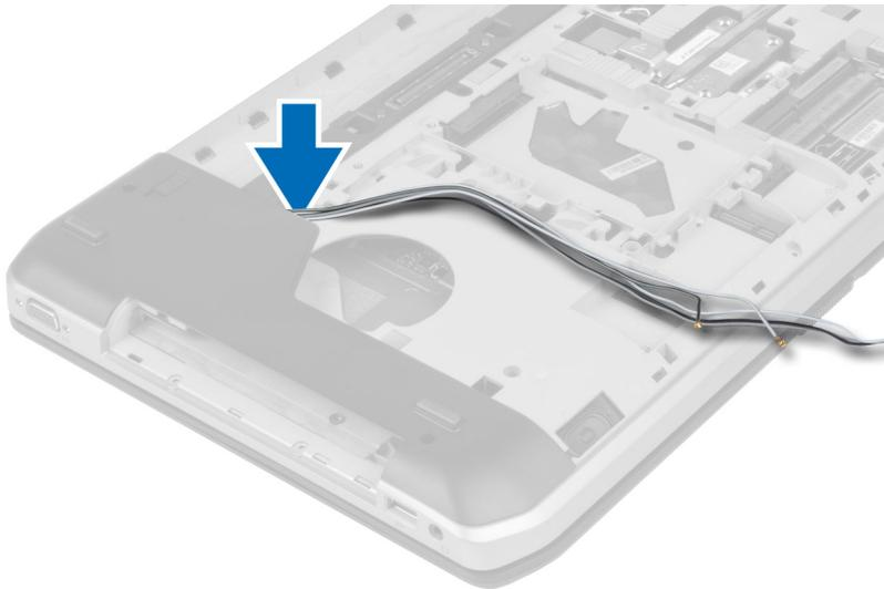
5. Ziehen Sie die Antennen durch die Öffnung zur Oberseite des Computers.
