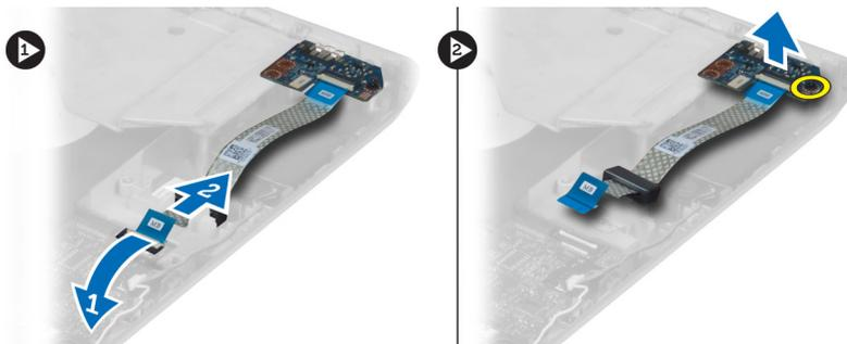
4. Entfernen Sie die Audioplatine aus dem Computer.
