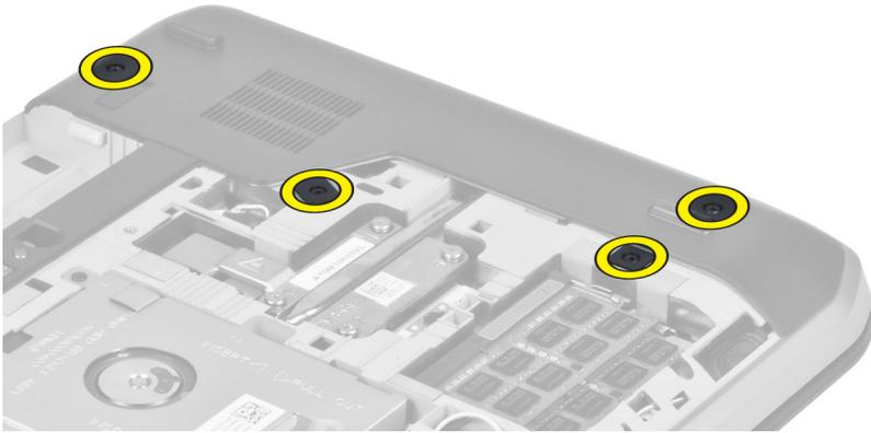
4. Entfernen Sie die rechte Bodenplatte vom Computer.
