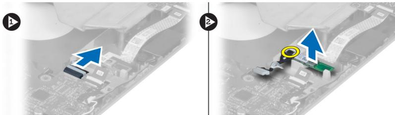
4. Entfernen Sie das Bluetooth-Modul aus dem Computer.
