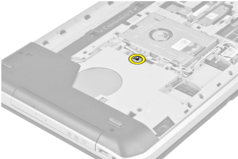
4. Drücken Sie die Schraubklammer vom Computer weg, um das optische Laufwerk aus dem Laufwerkschacht zu lösen.
