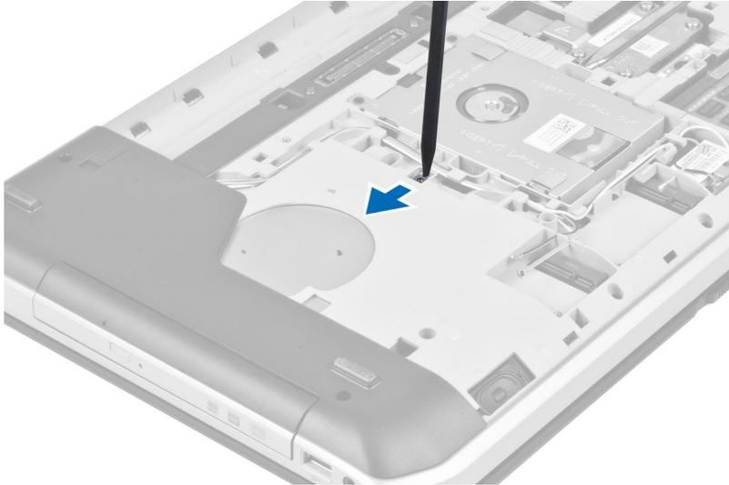
5. Entfernen Sie das optische Laufwerk aus dem Computer.
