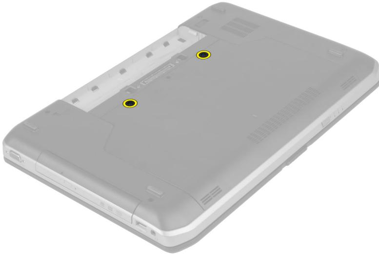
4. Schieben Sie die Abdeckung nach oben und entfernen Sie sie vom Computer.
