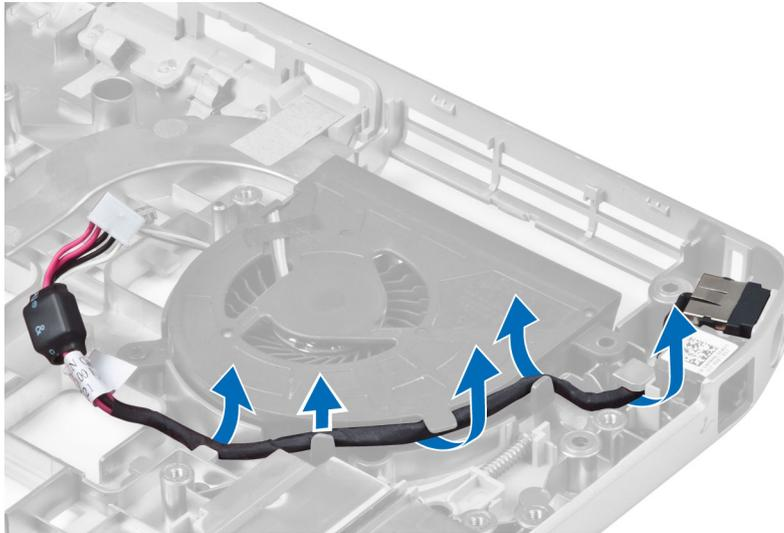
4. Entfernen Sie den Stromanschluss.
