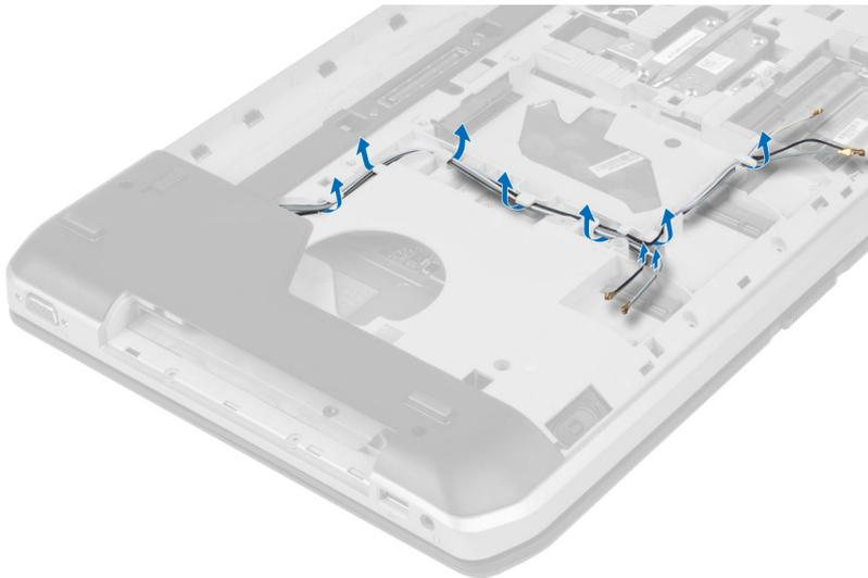
4. Ziehen Sie das LVDS-Kabel (Low Voltage Differential Signaling) ab.
