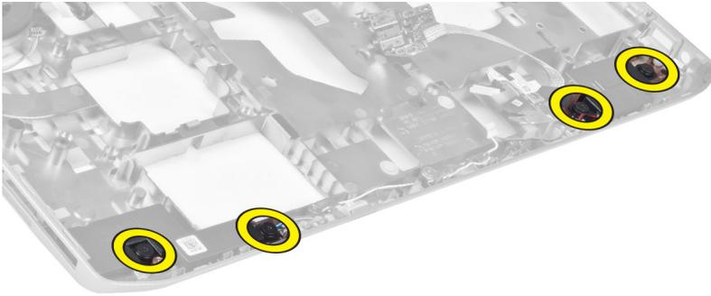
4. Entfernen Sie die Lautsprecher von den Kabelführungskanälen.
