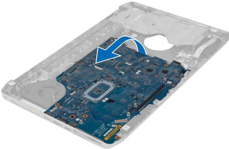
7. Lösen Sie die Systemplatine aus den Port-Anschlüssen auf der linken Seite und entfernen Sie die Systemplatine.
