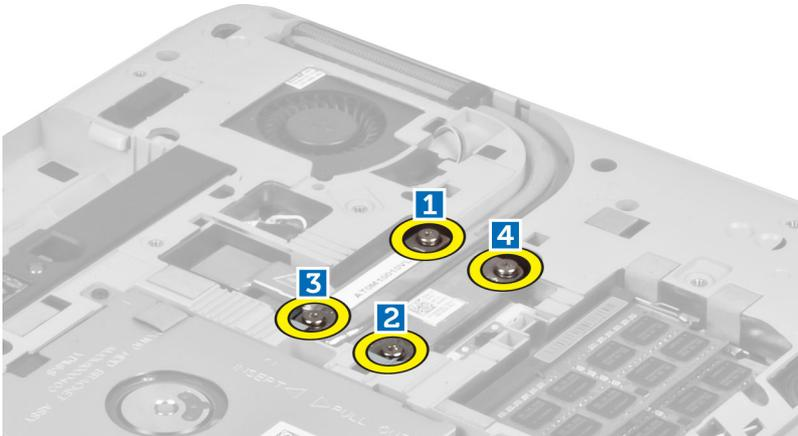
4. Heben Sie das Temperaturmodul an und entfernen Sie es aus dem Computer.
